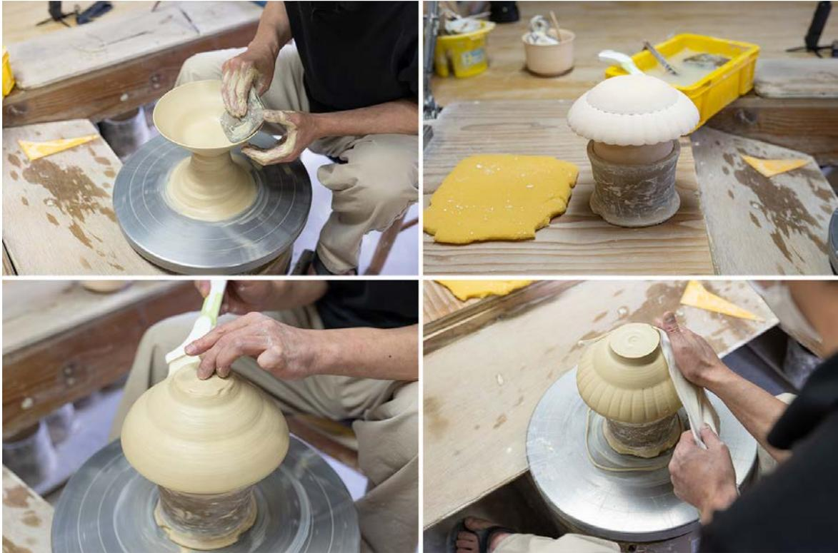
型打ち成形の手順。まず型の大きさに合わせてろくろを引き(左上)、型(右上)にろくろで引いた生地をかぶせ(左下)、上からなぞりながら型の模様を浮き上がらせる(右下)。
